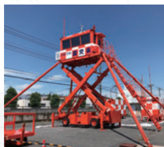
リフターを使用した管制塔システム
